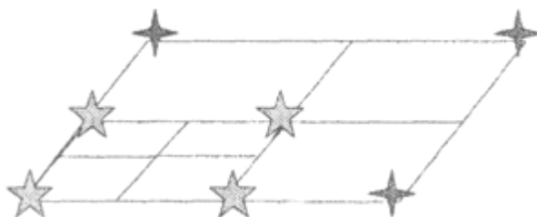
Рис. 1.19. Подгрид с высокой плотностью, с четырьмя ячейками, наложенный на базовый с низкой плотностью, также с четырьмя ячейками.
